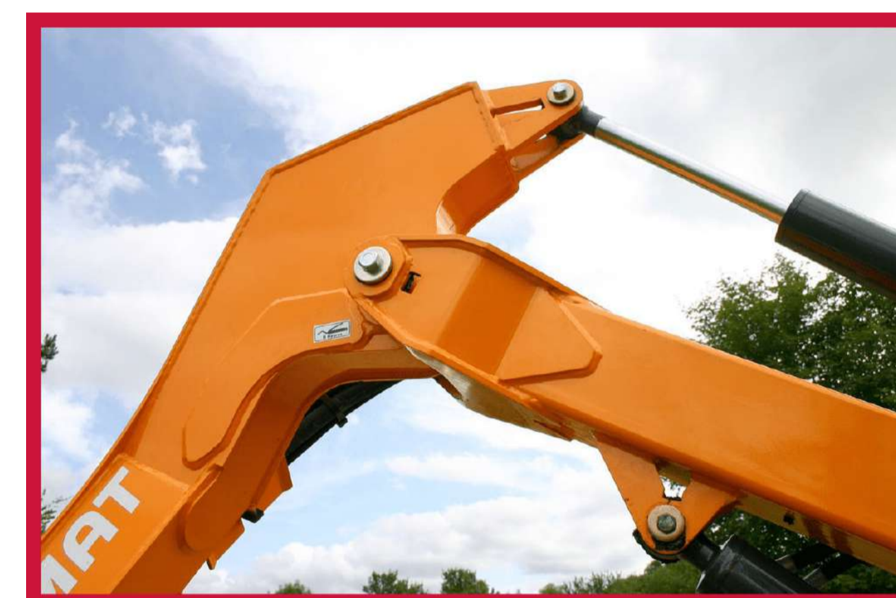
Отверстия в рукоятях и стрелах экскаваторов
