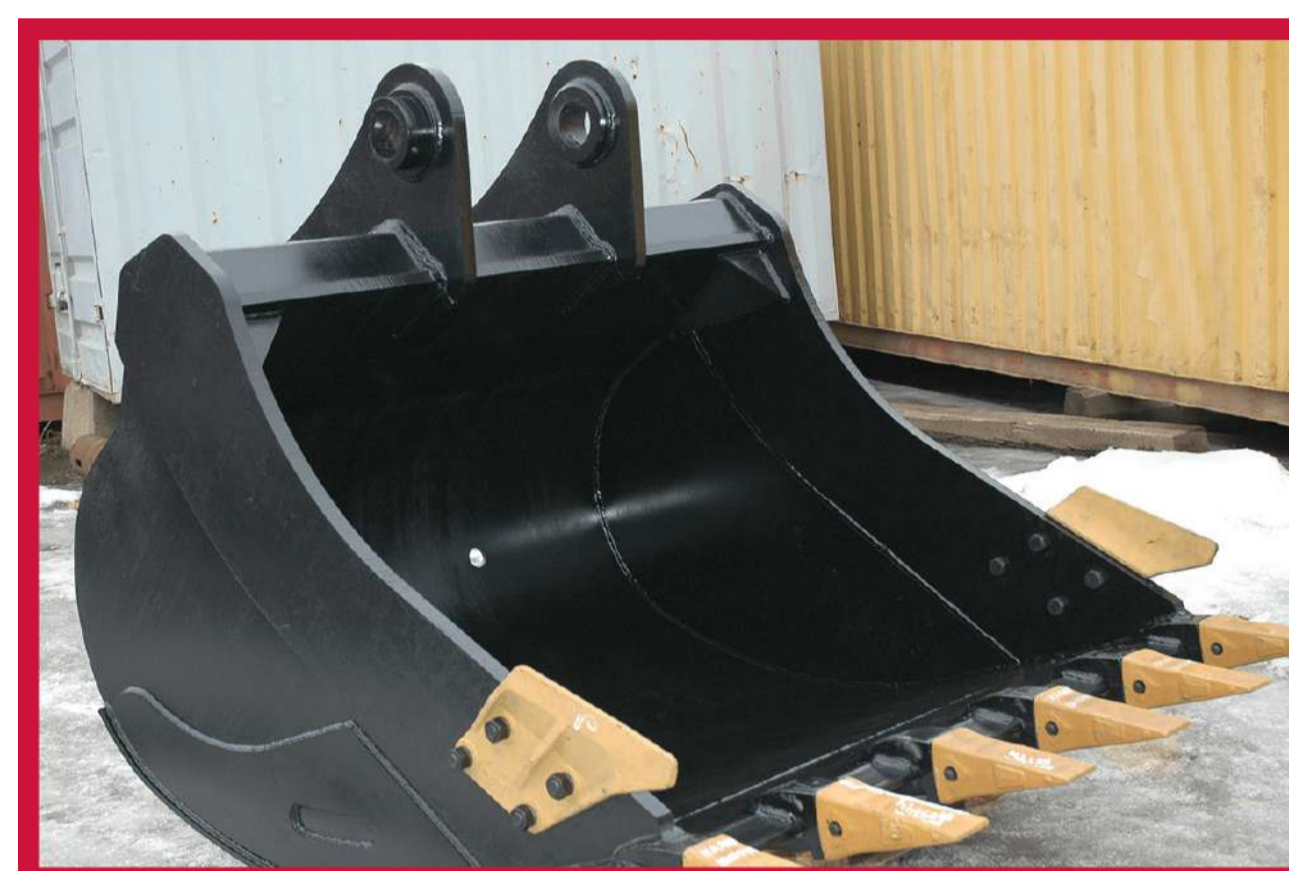
Отверстия в проушинах ковшей экскаваторов
